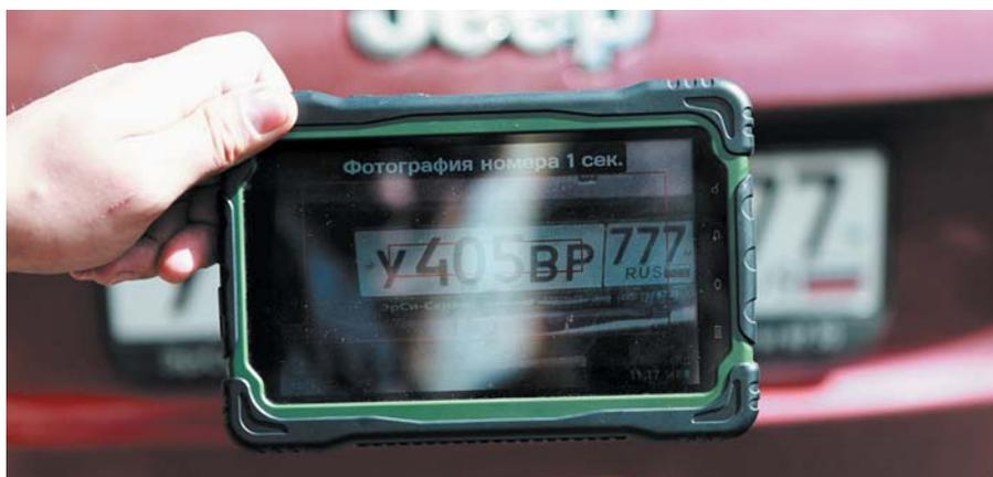
Рис. 4. Портативный комплекс фотофиксации «ПаркНет» на базе планшетного компьютера
