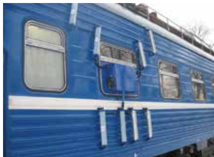
Рис. 1. ВИКС с установленным комплексом ВКУЗ
