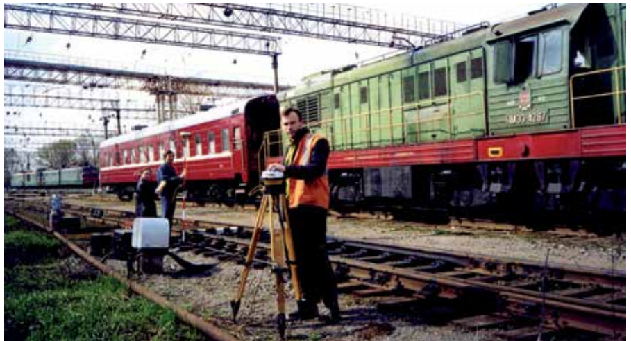
Рис. 3. Контроль параметров станционных путей
