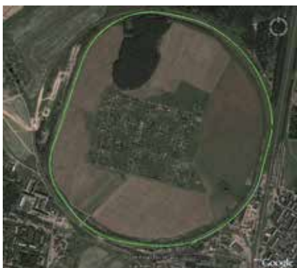
Рис. 2. Отметки точек позиционирования ЦНИИ-4 МД, наложенные на электронную карту Большого кольца в г. Щербинка
