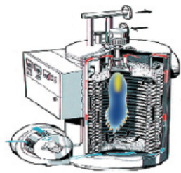
Рис. 2. Вертикальная компоновка термомасляного котла
