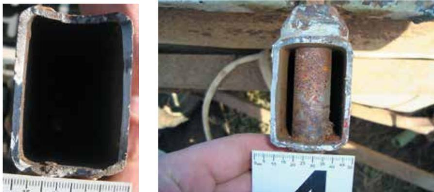
Рис. 3. Разрушение элементов несущей системы и ходовой части прицепных звеньев
