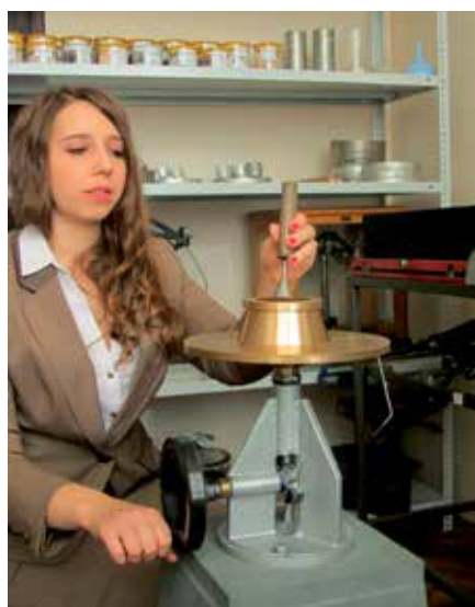
Рис. 1. Определение транспортабельного предела влажности железорудного концентрата Лебединского горно-обогатительного комбината
