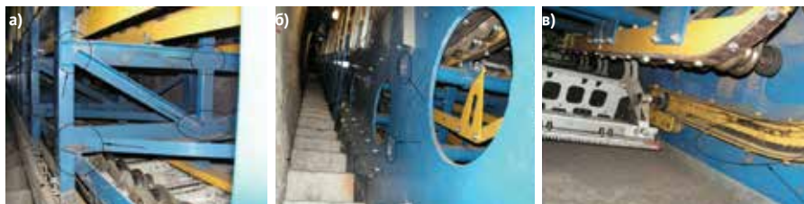
Рис. 4. Характерные места выборочного контроля: а – элементы ферм секций; б – вертикальные листы ферм; в – вертикальные листы креплений криволинейных направляющих
