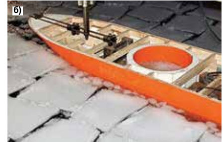
Рис. 2. Морская ледостойкая технологическая платформа судового типа с турельной системой удержания: а – общий вид; б – испытания модели в ледовом бассейне.
