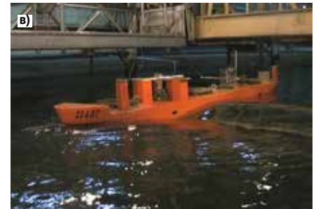
Рис. 3. Арктическое буровое судно с турельной системой удержания: а – общий вид; б – испытания в ледовом бассейне; в – испытания в мореходном бассейне.
