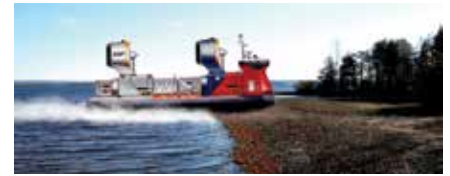
Рис. 9. Малое морское НИС на воздушной подушке для работы в переходной зоне «суша — море»
