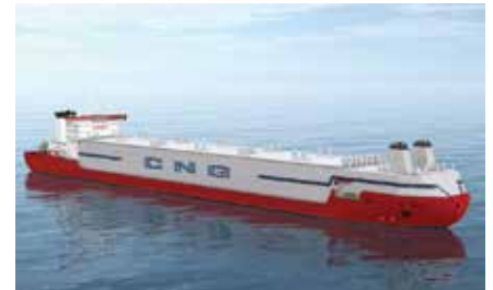
Рис. 10. Газовоз CNG вместимостью около 90 тыс. куб. м
