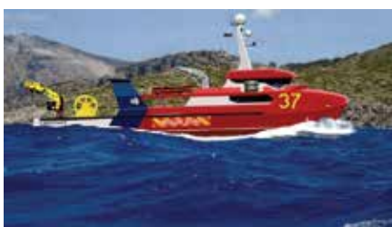
Рис. 8. Малое сейсмическое НИС-катамаран для работы с сейсмостанциями на мелководье
