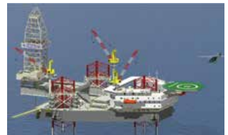
Рис. 4. Глубоководная ледостойкая самоподъемная плавучая буровая установка
