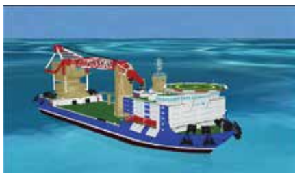
Рис. 6. Морское краномонтажное судно грузоподъемностью 3500 т ледового класса Arc4
