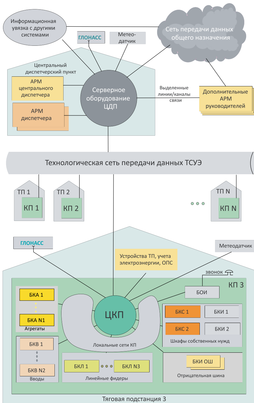
Автоматизированное управление исполнительными устройствами тяговых подстанций в технологическом процессе электроснабжения линий городского электротранспорта
