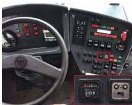
Рис. 6. Индикация системы контроля утечки газа на щите приборов
