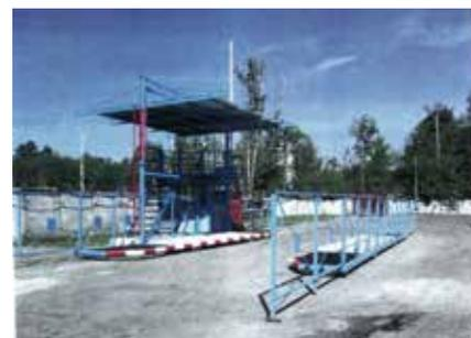
Рис. 1. Временный (до реализации проекта) сборно-разборный пост контроля, аккумулярования и сброса газа HO-160
