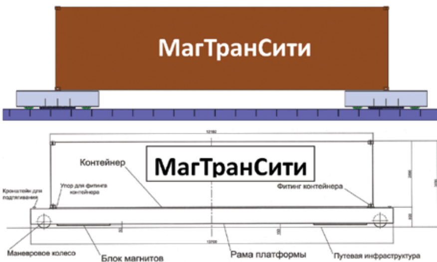
Рис. 7. Компонка и габариты проектируемой грузовой магнитолевитационной транспортной платформы
