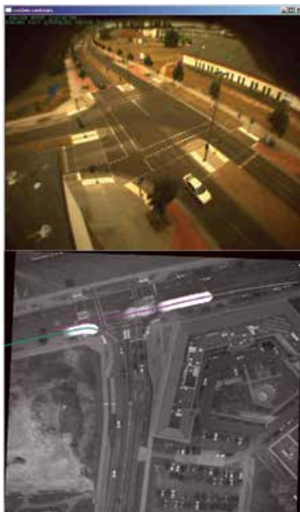
Рис. 3. Регистрация перемещений с помощью инструмента распознавания фона (вверху) и технологии отслеживания (внизу)
