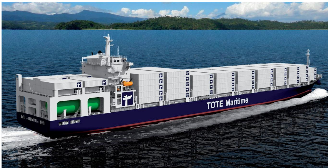
Рис. 6. Первый контейнеровоз, использующий в качестве топлива СПГ
