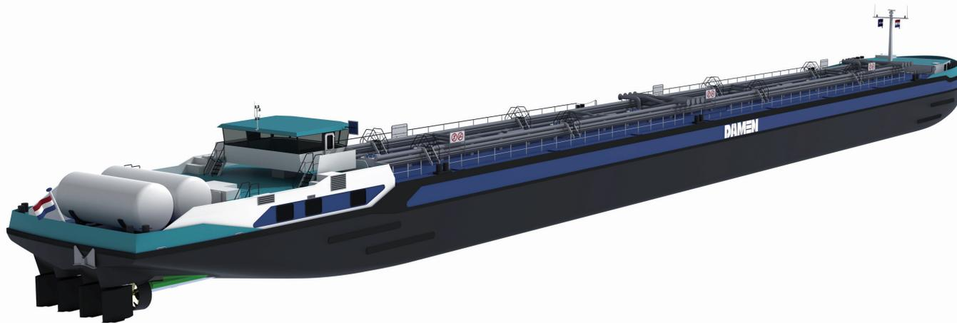
Рис. 9. Установка для использования СПГ в качестве топлива, включающая танки с бункеровочной вместимостью около 45 м<sup>3</sup> СПГ (расположена в кормовой части за жилыми помещениями)
