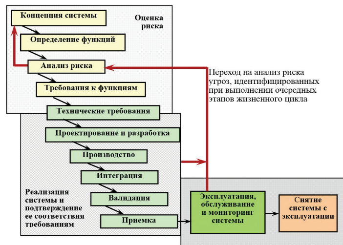
Рис. 1. Типовая модель жизненного цикла железнодорожных систем в соответствии с EN 50126
