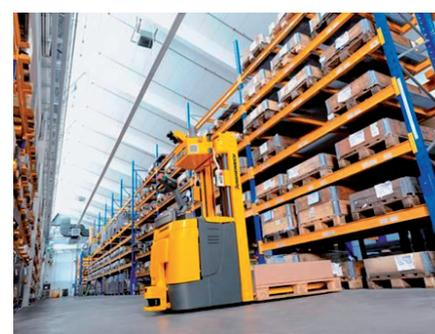
Рис. 9. Самодвижущийся погрузчик без водителя на складе
