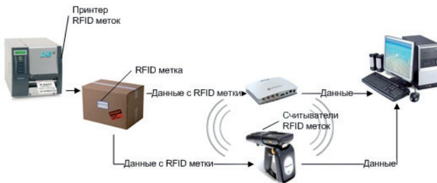
Рис. 2. Технология радиочастотной идентификации RFID
