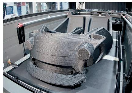
Рис. 6. Кузов автомобиля, отпечатанный на 3D-принтере
