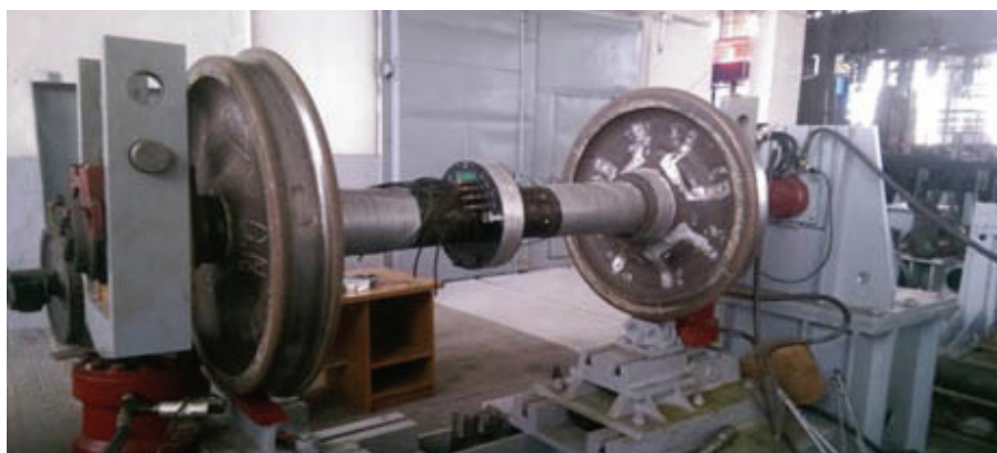
Тензометрическая колесная пара на стенде
