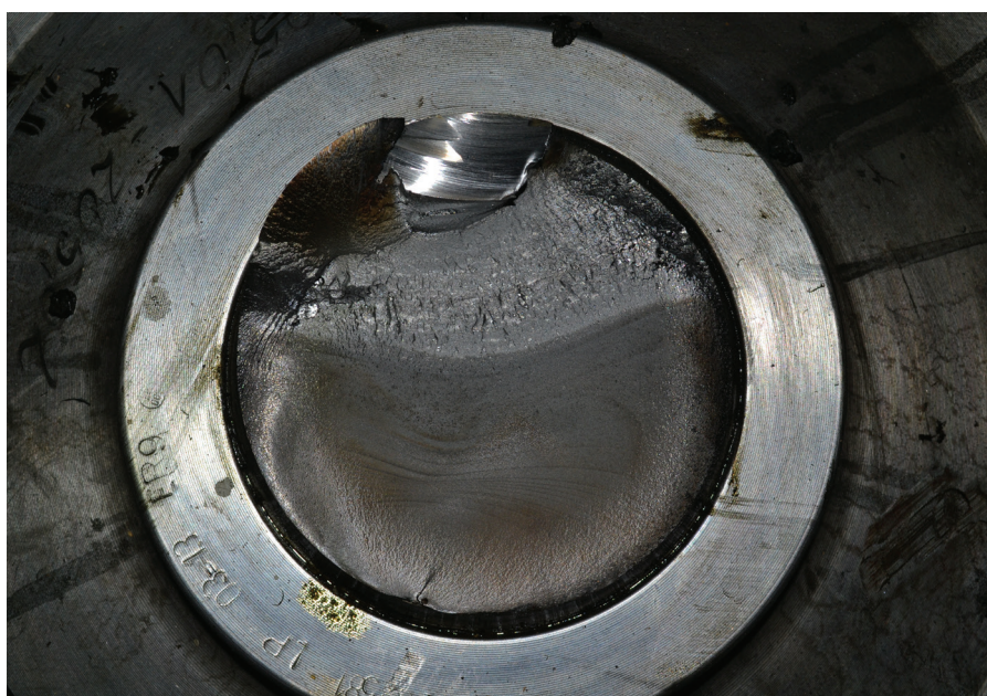
Фрактал излома оси колесной пары
