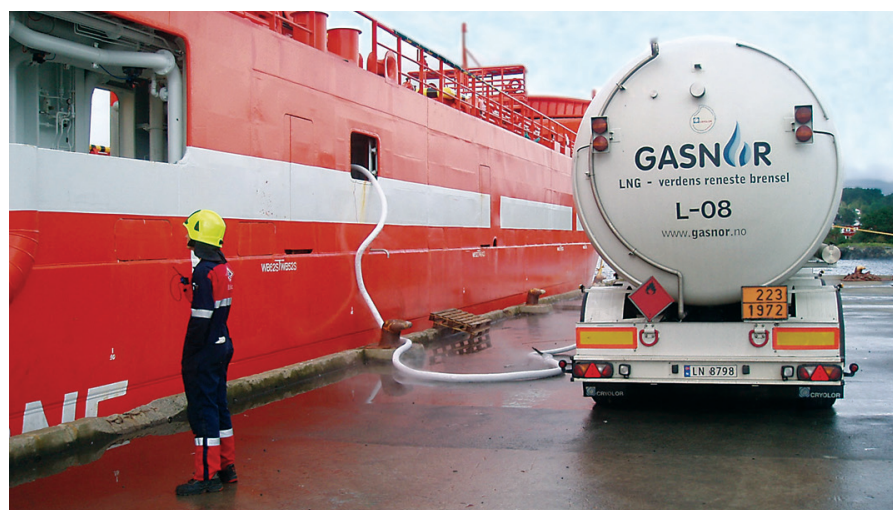
Рис. 3. Бункеровка судна с использованием автоцистерн
