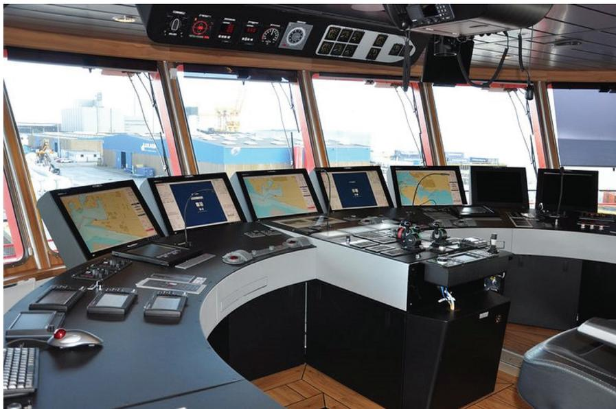
Рис. 1. Интегрированная мостиковая система
