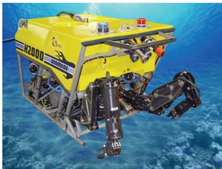
Рис. 2. Телеуправляемый необитаемый подводный аппарат
