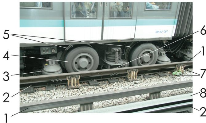
Рис. 1. Парижский метрополитен. Тележка вагона с пневматическими колесами: 1 – направляющие / контактные шины; 2 – ходовые рельсы; 3 – направляющие колеса на вертикальных осях; 4 – пневматические колеса; 5 – стальные железнодорожные колеса; 6 – токосъемный башмак; 7 – кронштейны-изоляторы, 8 – ходовая металлическая балка (дорожка). 2017 г. Фото Е. Комарова
