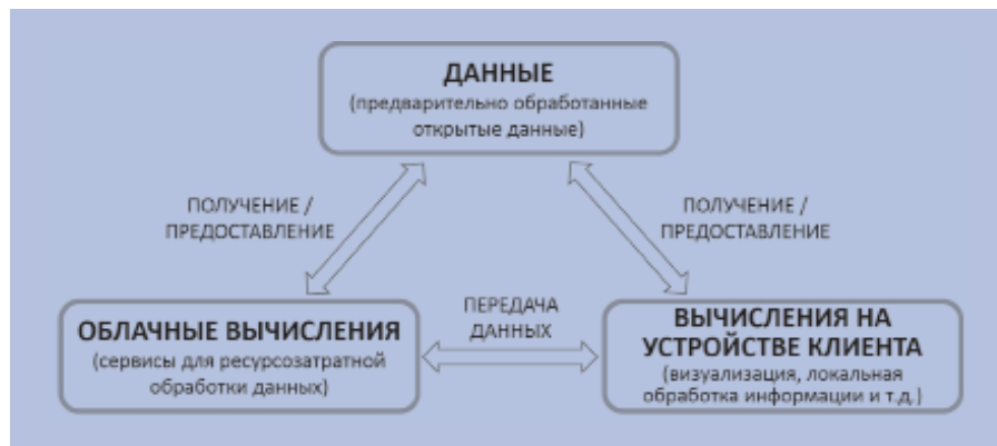
Рис. 2. Децентрализованный подход к агрегации разнородных данных
