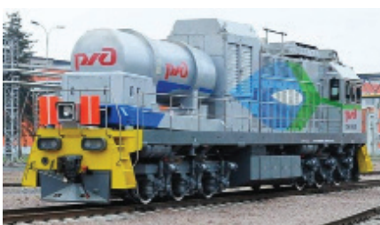
Рис. 1. Маневровый тепловоз ТЭМ19, работающий на сжиженном природном газе, с газовым поршневым двигателем
