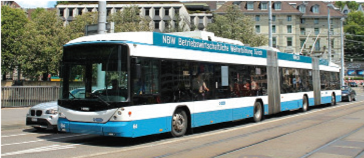
Рис. 2. Двусчленный троллейбус Hess LightTram длиной 25 м в Цюрихе
