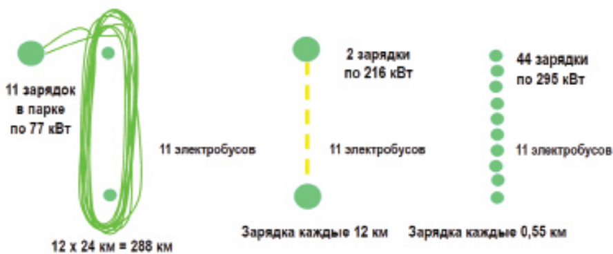
Рис. 1. Варианты зарядки электробусов
