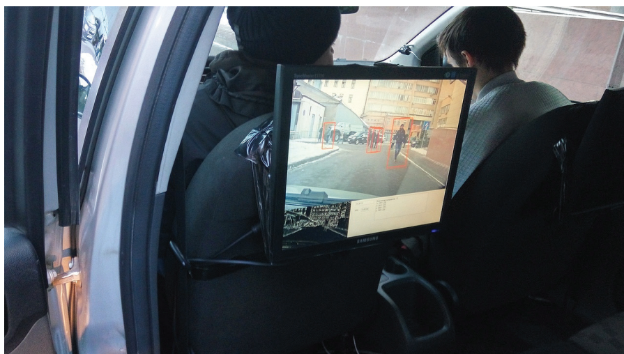
Рис. 3. Дублирование работы системы распознавания пешеходов на монитор
