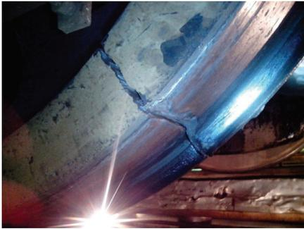
Рис. 6. Повреждение, начинающееся на ободу колеса
