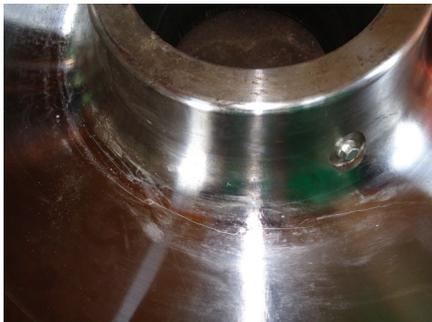
Рис. 7. Повреждение, начинающееся в зоне ступицы колеса
