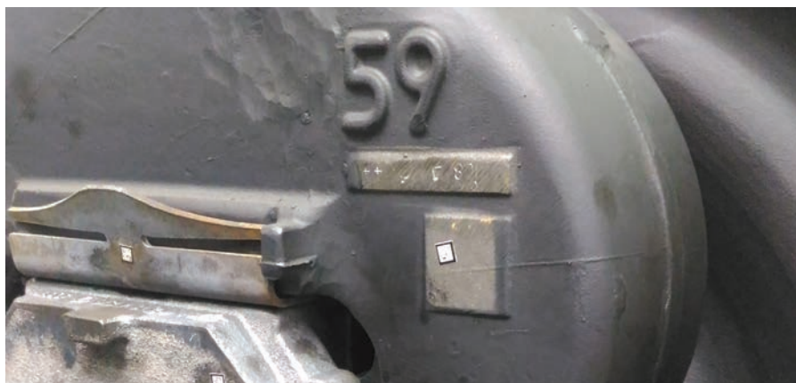
Рис. 1. Фрагмент тележки грузового вагона с установленными идентификационными метками
