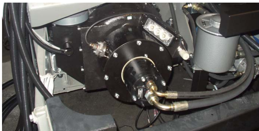
Двигатель 20M 3550 K/4 во время установки в троллейбус SKODA 24Tr IRISBUS. Направляющая кабеля с ответной частью с аксиальными гнездами модульного соединителя HС на 350 А, подключаемыми на конце
